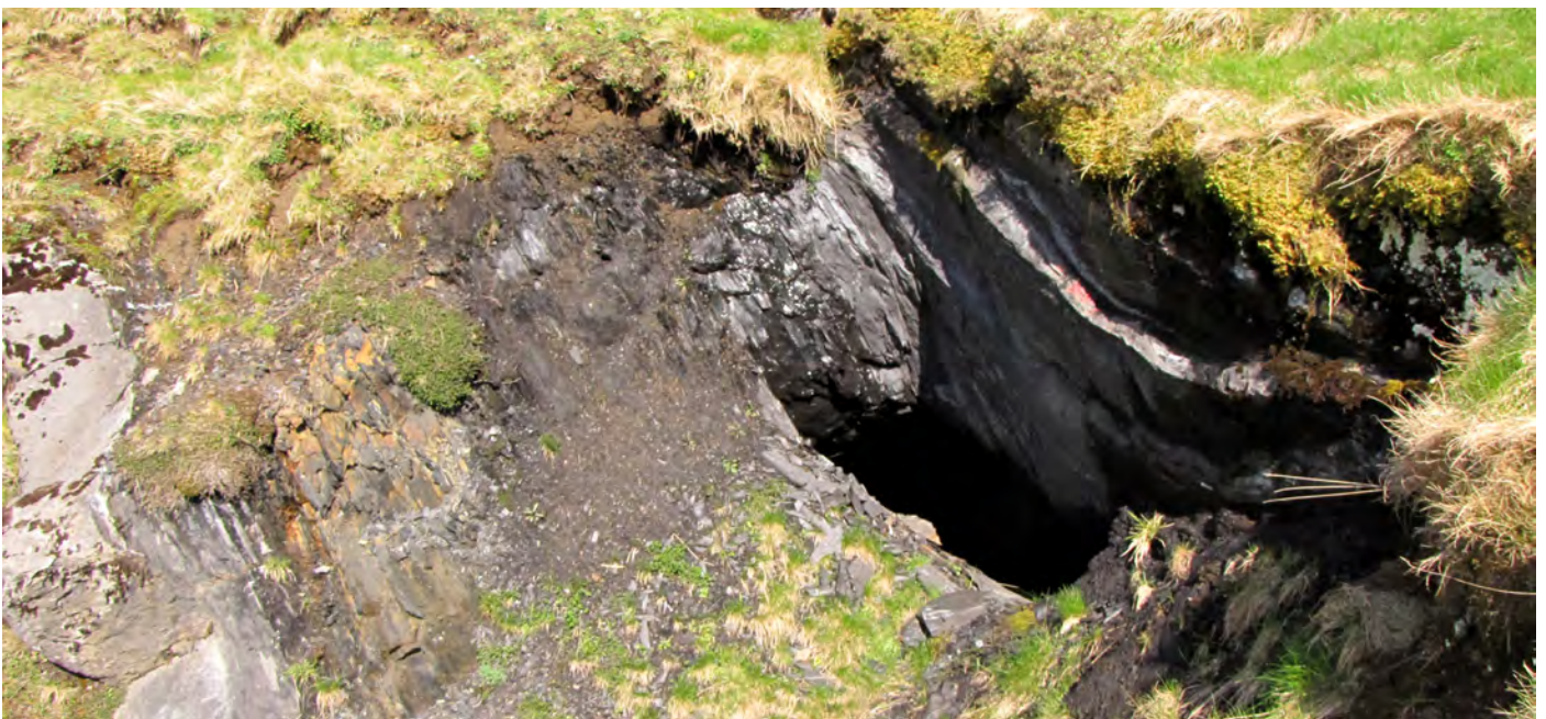
Entrada de las pequeñas galerías excavadas en el Purbeck perpendiculares a la estratificación para alcanzar la zona mineralizada.
